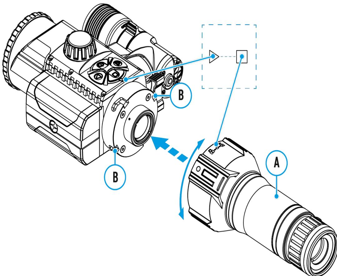
Il **monoculare Pulsar 5x30** (incluso nella confezione) consente di trasformare un dispositivo digitale in un dispositivo di visione digitale per l'osservazione notturna con un ingrandimento pari a 5x.
