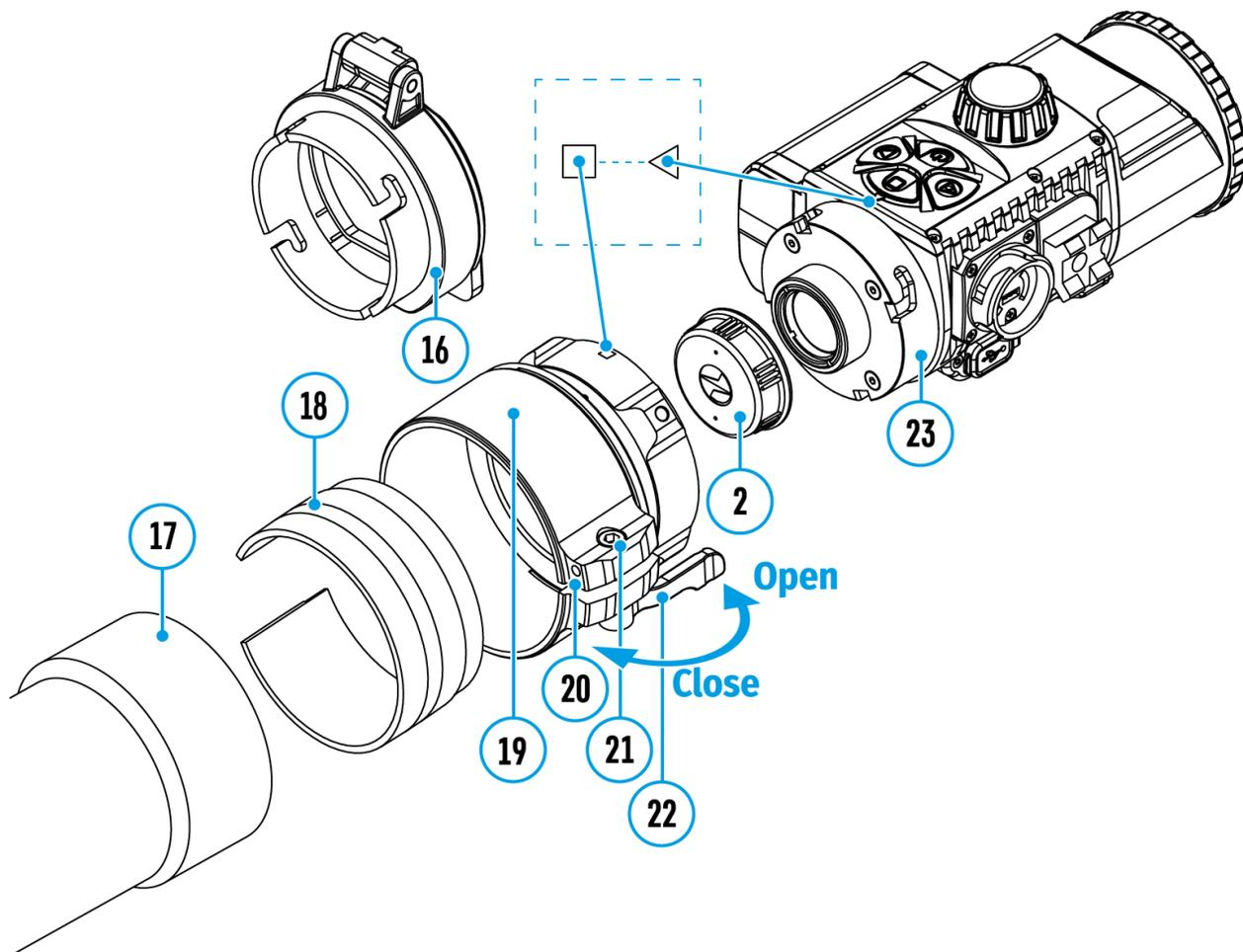
**1.** Selezionare l'adattatore (disponibile separatamente) con inserto di diametro previsto in funzione del diametro esterno dell'obiettivo del dispositivo ottico (vedere la **Tabella**).
