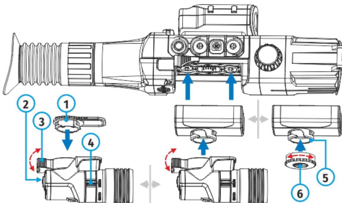
1. Se sul dispositivo è installato un illuminatore IR standard, bisogna rimuoverlo secondo il manuale d'istruzioni.
