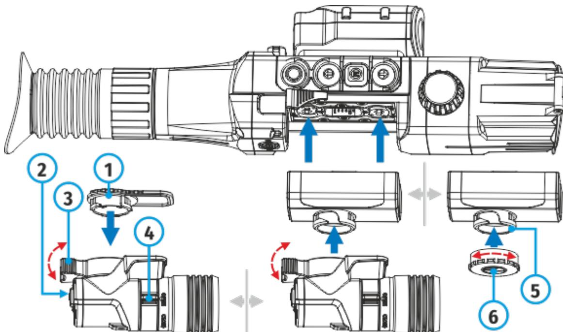
1. Per smontare l'illuminatore **Pulsar Ultra-X850S/-X940S**, bisogna alzare o abbassare la leva **(3)** (a seconda del tipo del dispositivo). Tirare delicatamente l'illuminatore nella direzione opposta al dispositivo.
